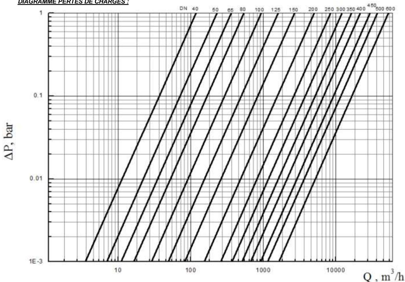
**VANNE A OPERCULE CAOUTCHOUC PN10/16 DIN COURT 3202-F4 FSH EPDM ACS**
