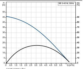
Liquide pompé = Eau T° liquide pendant le fonctionnement = 20 °C Masse volumique = 998.2 kg/m³
