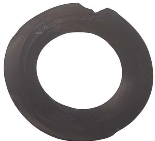
Pour garantir une liaison fiable, les boulons doivent recevoir une précontrainte suffisante. Cette précontrainte met le joint sous une certaine pression de surface, en fonction du diamètre de la bride et de l'application. On constate alors que, dans le cas des joints caoutchouc-acier avec o-ring, le caoutchouc se déplace de façon **incontrôlée**.
